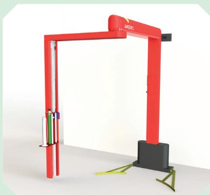
Dieser Maschinentyp wird vorzugsweise beim Einsatz von Langgabelförderzeugen als Paar benutzt. Mit seitlicher Anfahrtsmöglichkeit. Typischer Einsatzbereich dieser Anlage ist die auftragsbezogene Kommissionierung. Diese Maschine muss an einer Wand befestigt werden.
