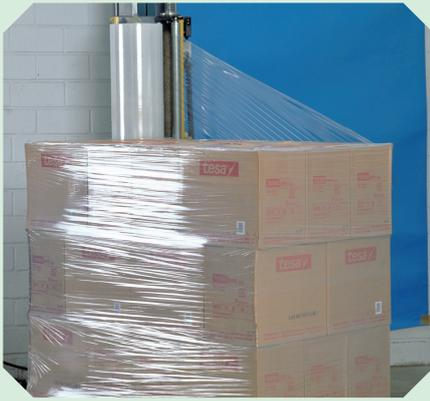
Diese orientierte Folie – **verwendbar nur für die Cobra-Maschinen** – bietet eine bessere Stabilität, reduzierte Kosten und vermindert den Verpackungsabfall, mit bis zu 50% geringerer Folienverbrauch bei verbesserter Qualität. Für diese Folie ist kein Vorrecksystem erforderlich.
