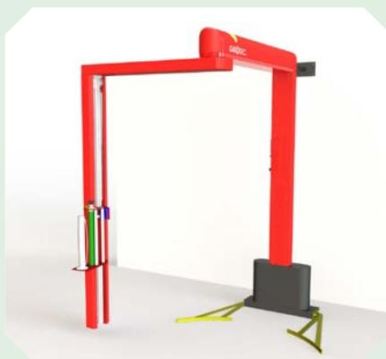
Dieser Maschinentyp wird vorzugsweise beim Einsatz von Langgabelförderzeugen als Paar benutzt. Mit seitlicher Anfahrmöglichkeit. Typischer Einsatzbereich dieser Anlage ist die auftragsbezogene Kommissionierung. Diese Maschine muss an einer Wand befestigt werden.
