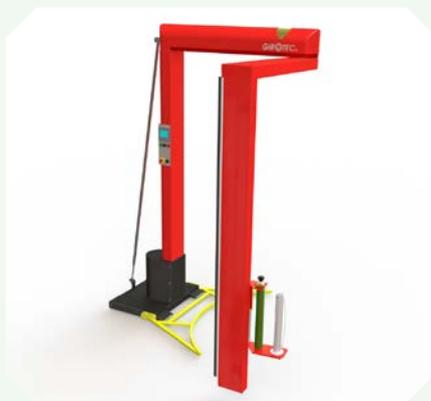
Dieser Maschinentyp wird vorzugsweise beim Einsatz von Langgabelförderzeugen als Paar benutzt. Mit seitlicher Anfahrmöglichkeit. Typischer Einsatzbereich dieser Anlage ist die auftragsbezogene Kommissionierung. Durch die Befestigung im Boden kann die Maschine frei im Raum stehen. ST3 mit längerem Ausleger für Paletten 1200x1200mm. Dieses Modell gibt es auch als „COBRA X“-Variante für eine maximale Palettenhöhe bis 2.450 mm.
