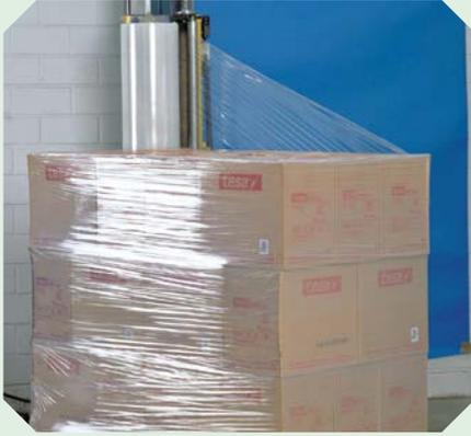
Diese orientierte Folie – **verwendbar nur für die Cobra-Maschinen** – bietet eine bessere Stabilität, reduzierte Kosten und vermindert den Verpackungsabfall, mit bis zu 50% geringerer Folienverbrauch bei verbesserter Qualität. Für diese Folie ist kein Vorrecksystem erforderlich.
