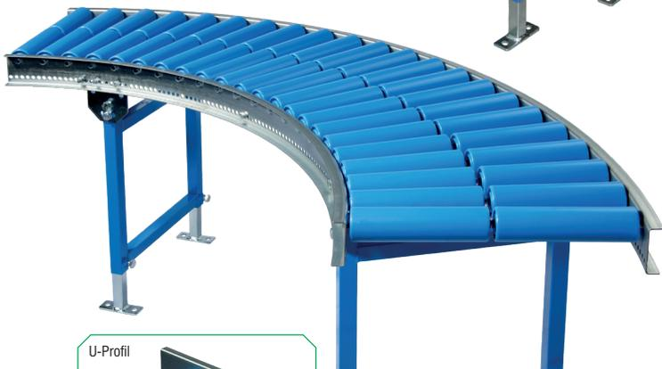
**Leichtrollenbahn, 600 mm Breite, Rollenteilung 75 mm, Tragrollen aus Kunststoff, Ø 50 mm, alle Doppelständer von 550 bis 850 mm höhenverstellbar**
