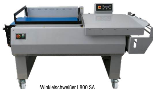
Winkelschweißer L800 SA
